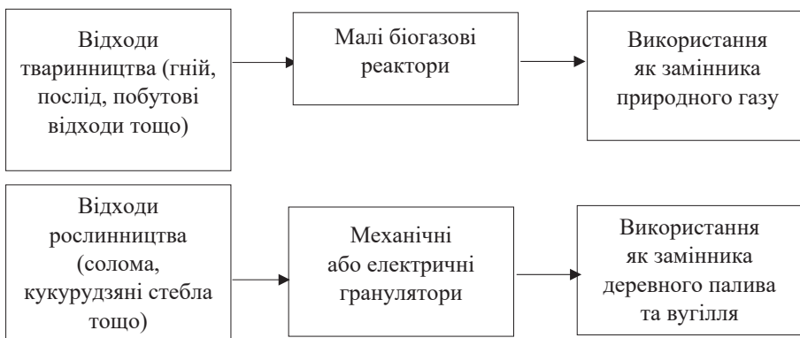
Рис. 2. Принципова схема переробки відходів сільськогосподарської діяльності в особистих селянських господарствах на біогаз та тверде біопаливо
